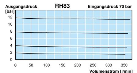
\*1 bei P<sub>1</sub> = 70 bar, P<sub>2</sub> = 4 bar und Δp = 0,35 bar    \*2 04 = 0...4 bar, 11 = 0...11 bar, 16 = 0...16 bar
